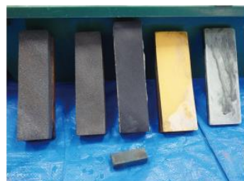
左端が荒砥、中央が中砥、右端が仕上砥。手前はさび落としに使用します。
